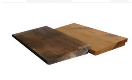
Detail nové a stářím zašedlé palubky kompletní dokončení procesu šednutí
