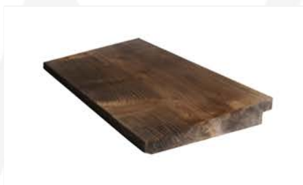
Detail po dokončení procesu šednutí více jak 5 let na přímé povětrnosti
